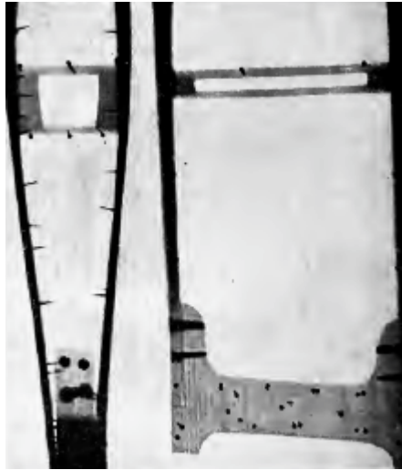
Fig. 83. - Membratura d'aeroplano in cui si vedono delle spaccature del legno prodotte dalle viti.
