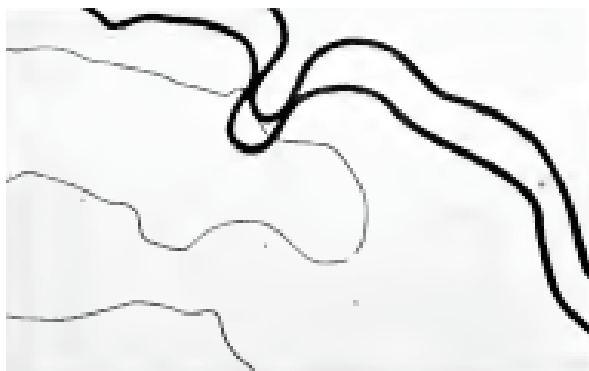
Fig. 85. - Giacca di pilota d'aeroplano con riscaldamento elettrico. Un filo rotto.
