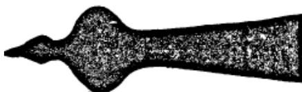
In questa figura le dimensioni orizzontali sono semplicemente raddoppiate, quelle verticali sono 200 volte più grandi. L'ingrandimento della parte stretta mostra l'azione della diffrazione.
